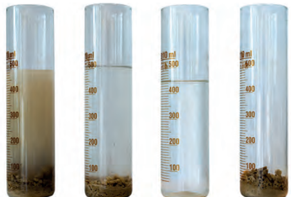
Aufspaltung in Wasser und Feststoffe durch Zugabe von Flockungsmittel und Mehrfachfiltrierung.
